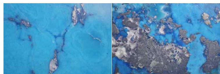
टर्क्वॉइज़ में भरी हुई नसों और गुहाओं को रंगीन बहुलक के साथ भरा जाता है। छवि में गहरे नीले रंग की सांद्रता पर ध्यान दिया जा सकता है।
